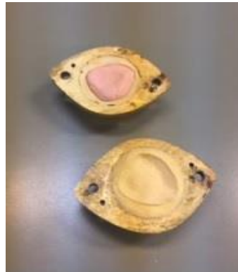
Figura 9: Mufla em gesso com formato copiado do molde em alginato.
