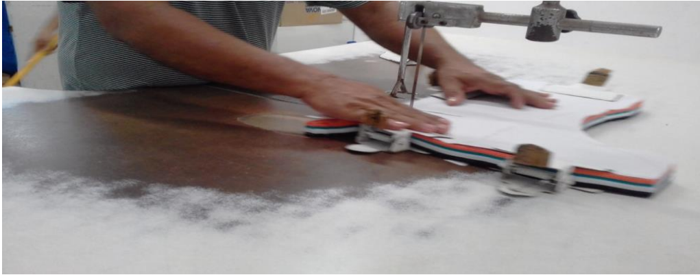
Figura 2. O funcionário no setor de corte sem a luva de malha de aço.
