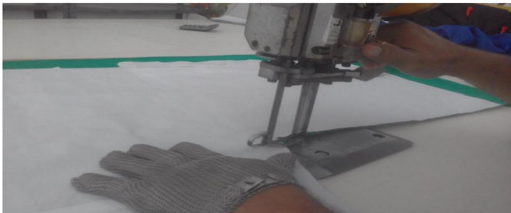
Figura 3. O funcionário no setor de corte com a luva de malha de aço.
