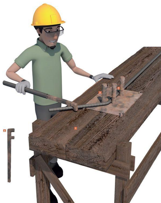
Figura 5: Bancadas de dobrar ferro
