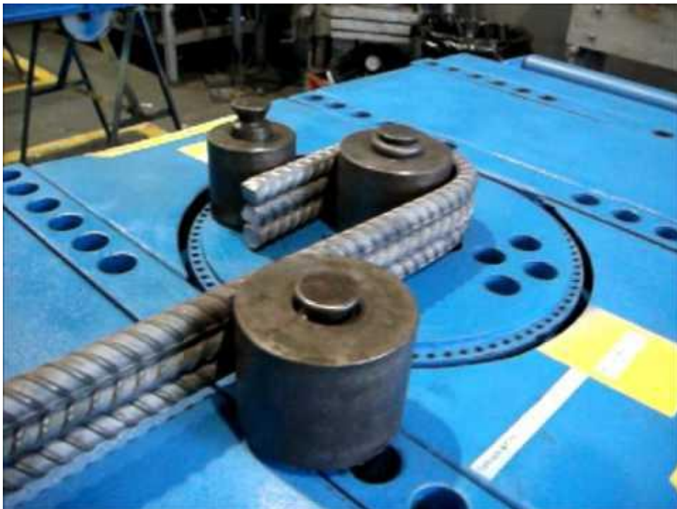
Figura 6: Máquina de dobragem hidráulica
