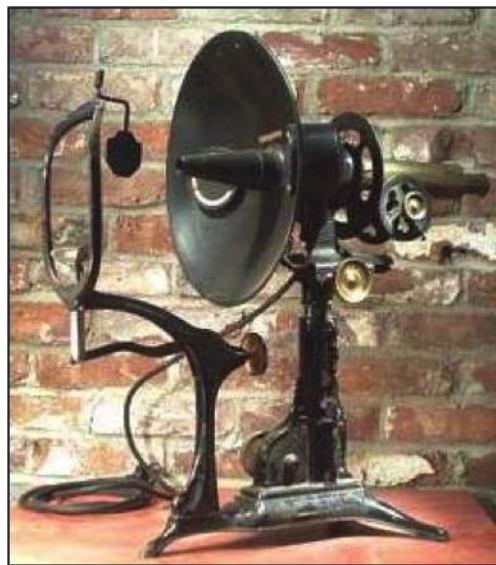
Figura1: Ceratômetro de Helmholtz, 1854.
