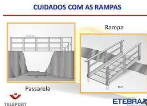
Figura 14: Proteção de Vão de Rampas
