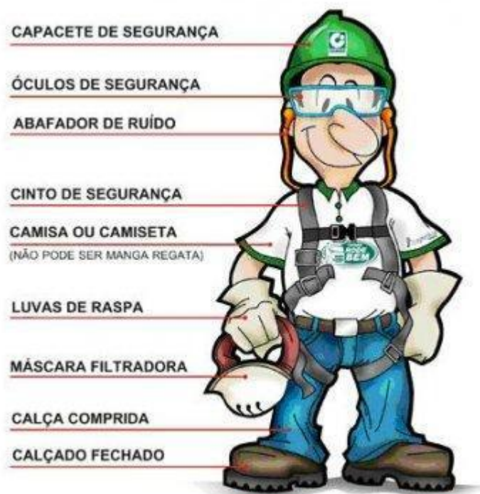
Figura 9: Montagem específica de todos os EPIs necessários para a construção civil.
