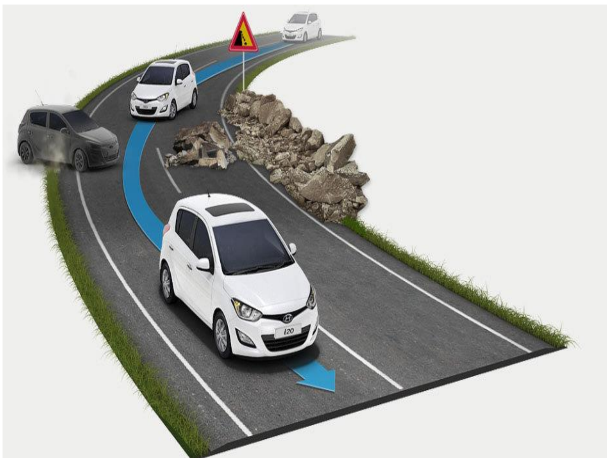
Figura 4 - Demonstração do funcionamento do sistema (ESP)
