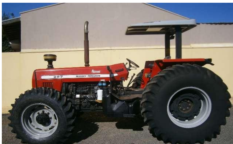
Figura 3. Massey Ferguson 297 de 120 cv e 6 cilindros.
