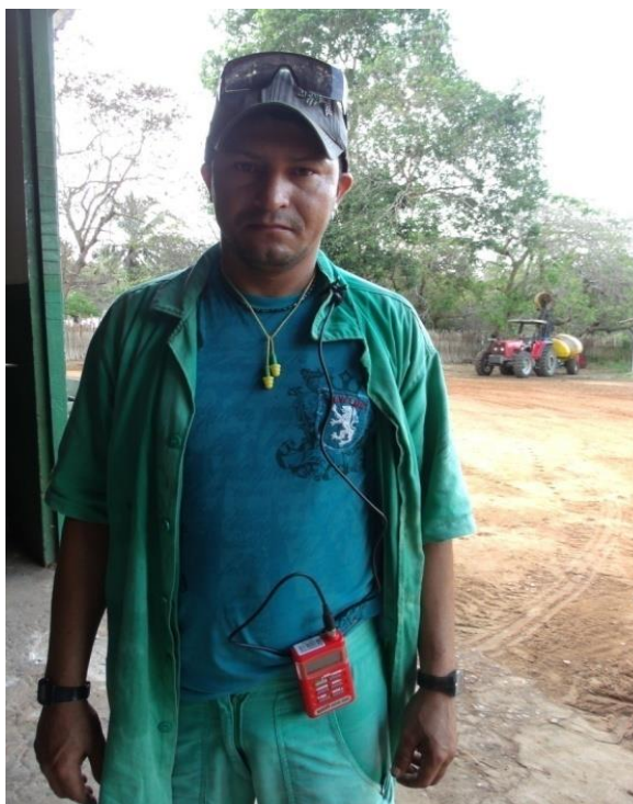
Figura 2. Dosímetro instalado no operador de máquinas
