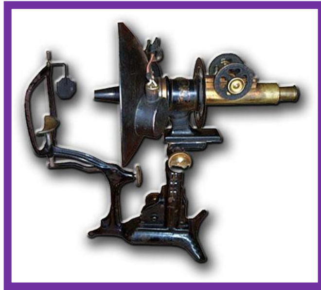
Figura 3. Primeiro modelo do oftalmoscópio de Helmholtz
