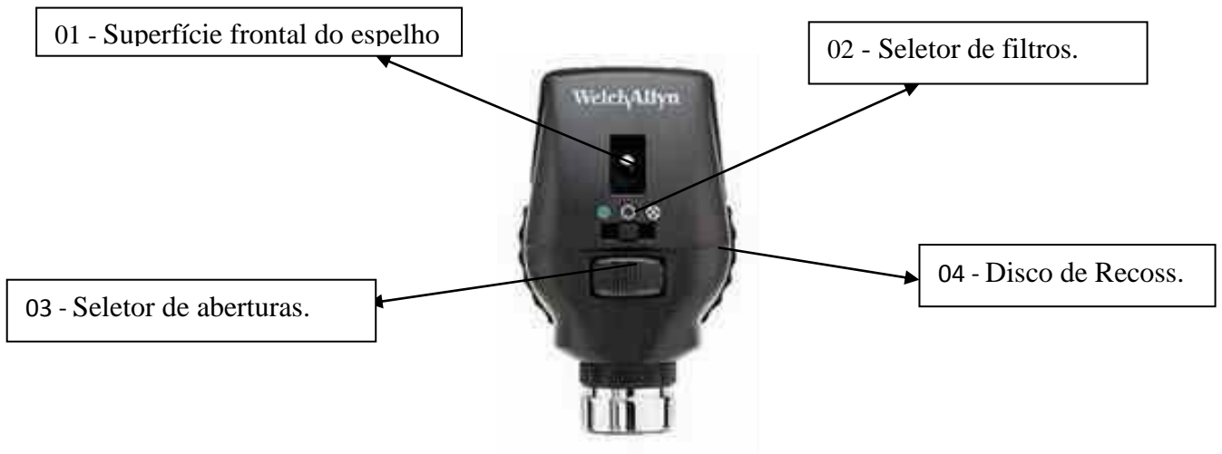
Figura 09 – Partes do oftalmoscópio. (Fonte: FISIOSTORE, Online ).
